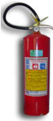
6) **EXTINTOR PORTÁTIL DE PÓ QUÍMICO SECO ABC DE 12 kg:** com carga classes BCY-95 capacidade 12 kg, pressurizado, com válvula em latão forjado tipo intermitente manômetro capacidade de 0 a 21 kgf, saia plástica de polietileno de alto impacto anti-faísca, pré-tratamento do cilindro com fosfatização interna e externa, pintura de acabamento em epóxi conforme norma NBR 10721 da ABNT de fabricação e para performance de capacidade extintora conforme norma NBR 9444. **IMAGEM MERAMENTE ILUSTRATIVA.**
